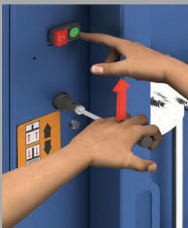
7. A corsa completa, premere il pulsante di avviamento e spingere la valvola a leva verso l'alto.
